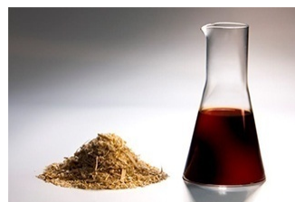
شکل ۵. روغن زیستی تولید شده از خرده‌های چوب در طی فرآیند گرماکافت
