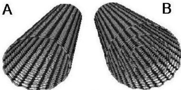
شکل ۲- نانولوله های کربنی تک جداره (A) و چند جداره (B) (اعتمادی و همکاران، ۲۰۱۴)
